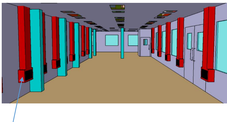
Return air risers
